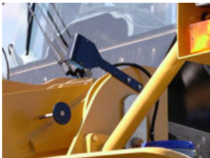
2 Emelőkar helyzetérzékelő, mely engedélyezi a mérést, ha az emelőkar a megfelelő helyzetben van.
